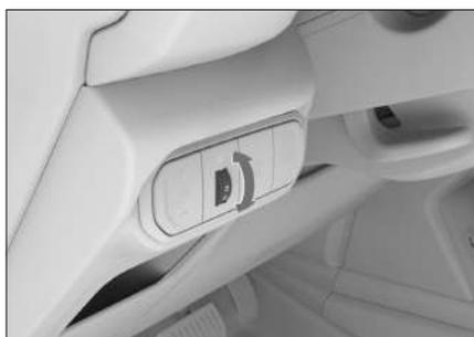
Puede ajustar la altura del haz de los faros según el número de ocupantes y la carga del vehículo.
