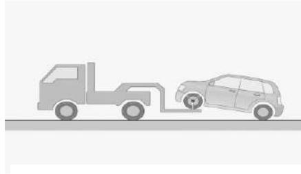
Las ruedas traseras y los ejes del vehículo están en buen estado. Suelte el freno de mano y bloquee el vehículo firmemente.
