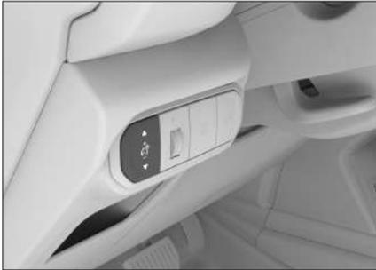
Cuando la luz de posición está encendida, se puede ajustar el brillo de las luces de fondo del panel de instrumentos y del vehículo entero.
