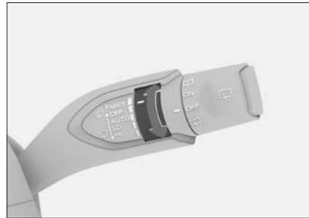
se cambia la sensibilidad de precipitación pluvial del sensor de lluvia y de iluminación a través de girar el botón giratorio, con lo cual se cambia la frecuencia de limpieza del limpiaparabrisas delantero en caso de que esté en la posición de limpieza automática.
