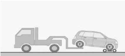
El tráiler debe colocarse debajo de las ruedas delanteras del auto y bloquearse firmemente.
