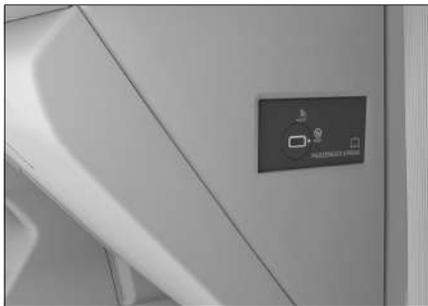
Interruptor de Airbag del lado del copiloto está en el lateral del panel de instrumentos del lado del copiloto.
