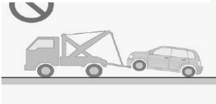
Ante una emergencia, si no puede usar un vehículo profesional para remolcar, puede usar temporalmente un gancho de remolque para remolcar el vehículo. Este método de remolque solo puede remolcar una distancia corta sobre un pavimento duro a baja velocidad.
