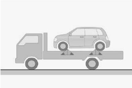
Al remolcar con un camión de Plataforma abierta, el vehículo debe estar bloqueado firmemente.
