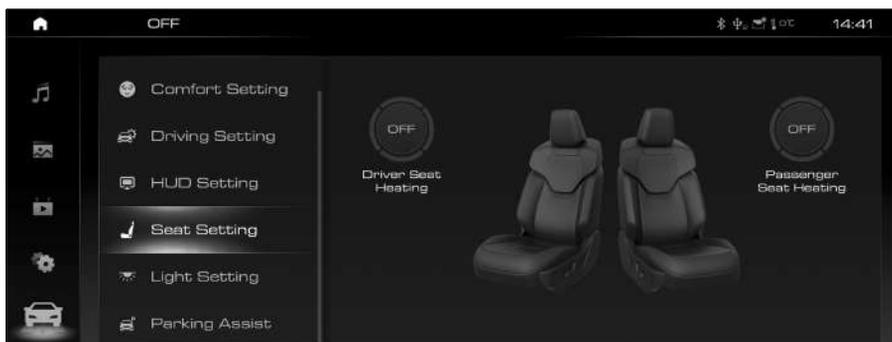
Toque repetidamente el botón de calentamiento del asiento para ajustar el nivel de calefacción del lado correspondiente del cojín del asiento o apagar la calefacción.
