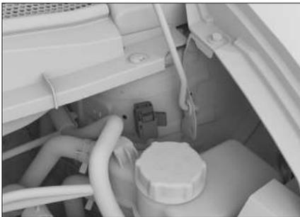
El interruptor de seguridad de la batería está situado en el compartimiento del motor, cerca de las barras de soporte y es visible cuando se abre e capó, y se utiliza para desconectar o conectar la alimentación del sistema de alta tensión.
